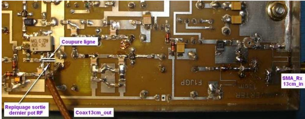
Coupure de la ligne 50Ω\_ entre sortie du dernier pot RF et entrée mélangeur
