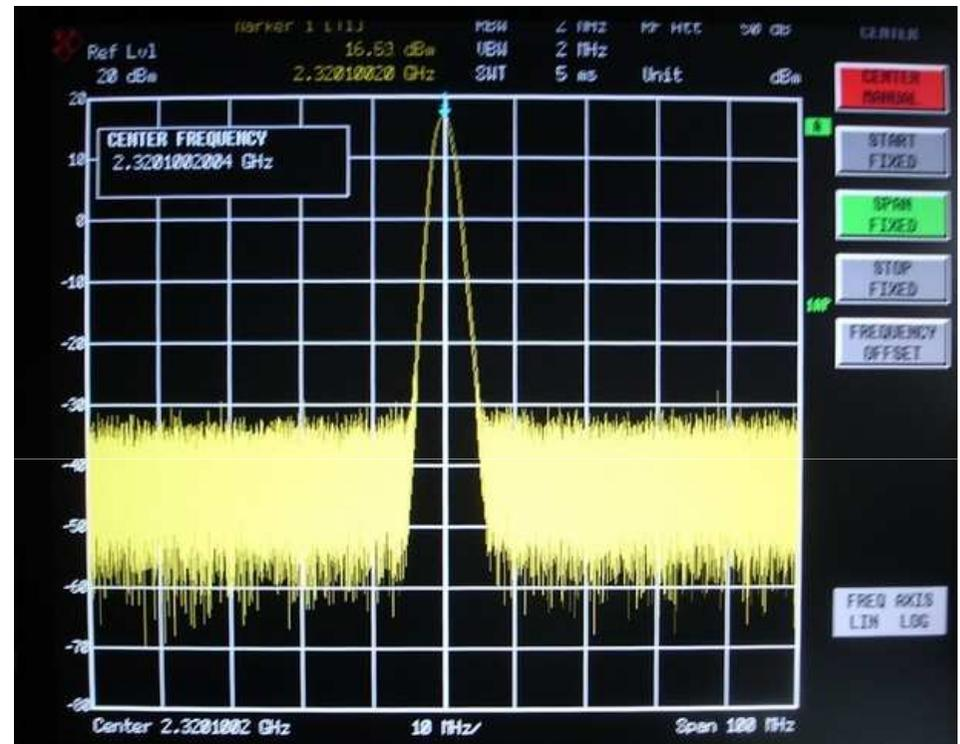
Coffret fermé, Pmax out = seulement +28.8dBm ou 760mW !
