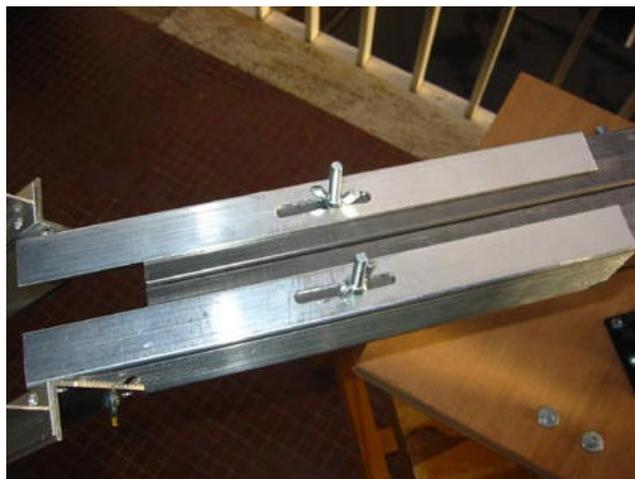
Figure 23 Plan incliné fraisage droit (à la perceuse)
