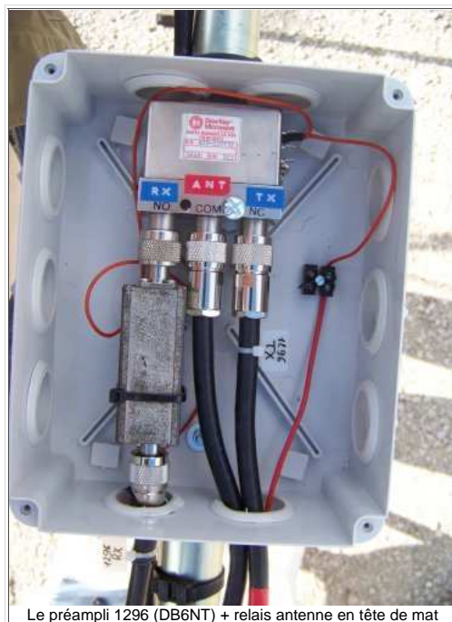
Le préampli 1296 (DB6NT) + relais antenne en tête de mat
