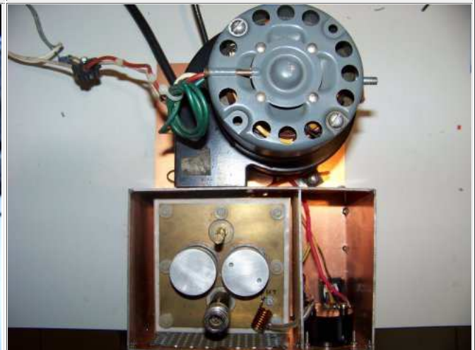
Le coffret en epoxy avec l'ampli, la soufflerie et l'arrière de la façade (polar + mesure)
