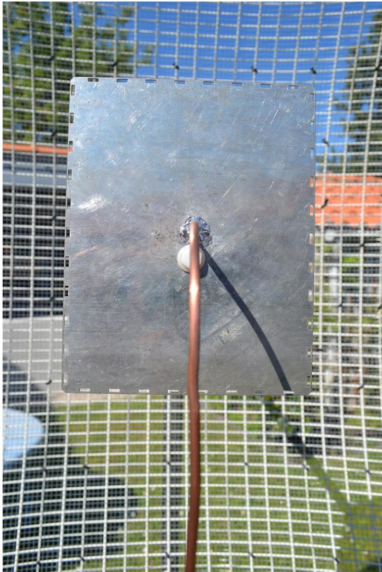
La liaison UHF est réalisée avec du coaxial UT141 et une fiche N.
