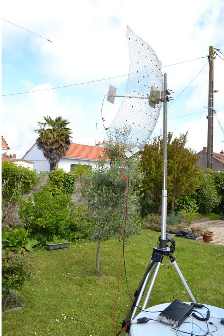
Reste plus qu'à installer cette antenne plus en hauteur afin d'écouter les nombreuses balises terrestres disponibles dans la bande 13cm et réaliser aussi des liaisons bilatérales...
