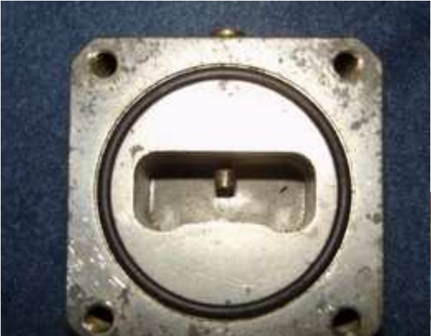
WR90/SMA Sodielec à F1CNE : - 0.32 dB
