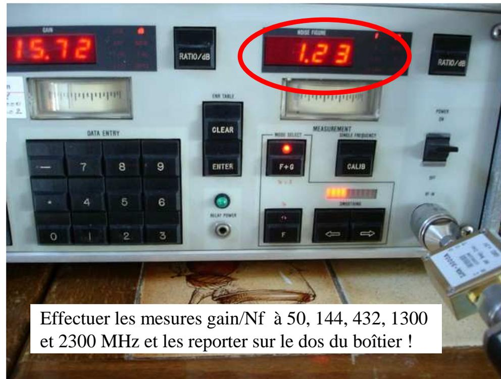
Effectuer les mesures gain/Nf à 50, 144, 432, 1300 et 2300 MHz et les reporter sur le dos du boîtier !
