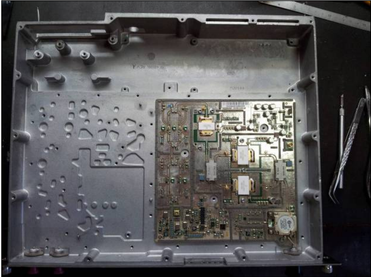
Figure 2 Vue du PA en cours de modification
