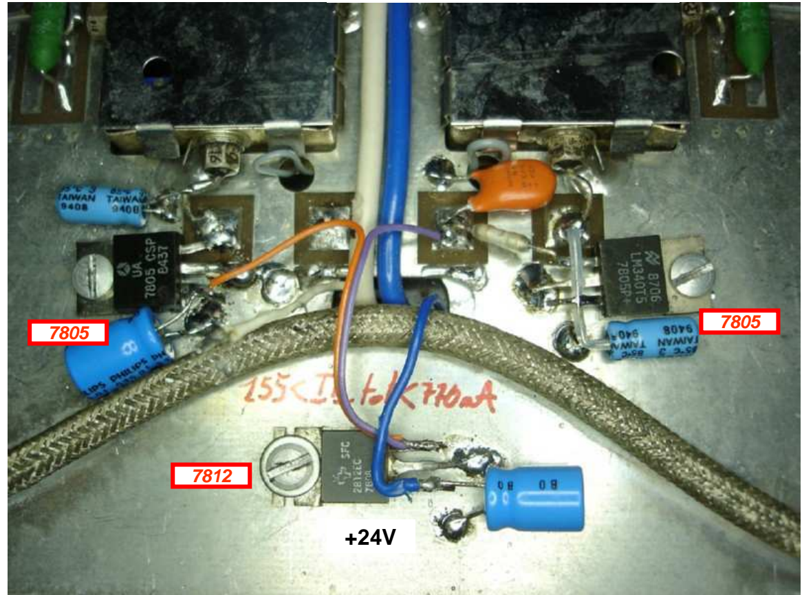
Montage d'un 7812 en amont
